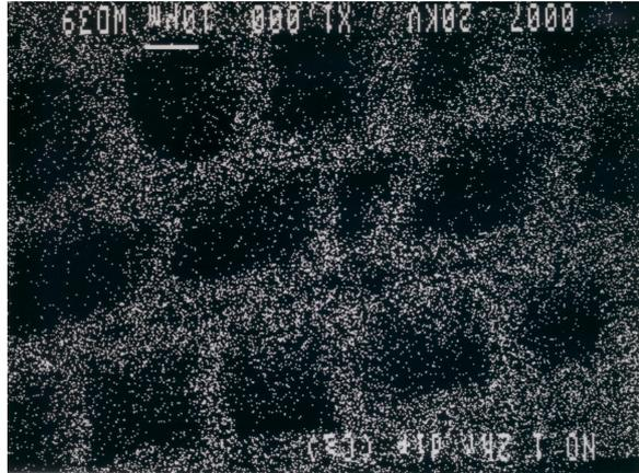
上記の写真はS2層を中心とする細胞壁へ球状のコロイドガラスが分布した様子を電子顕微鏡写真で撮影したものです。
